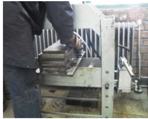
شکل ۵. نمایی از نحوه ساخت و تراکم دال
