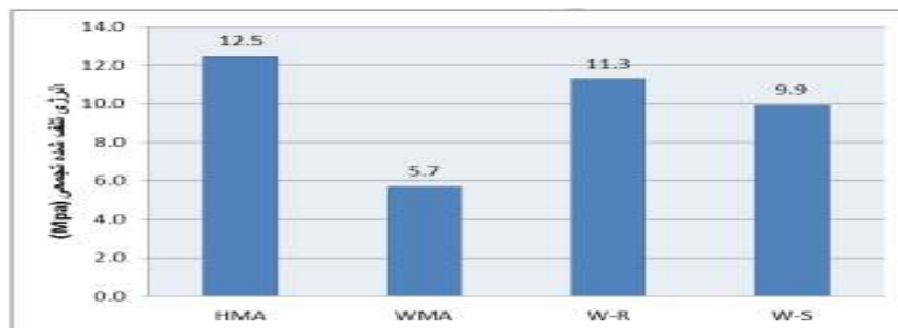
شکل ۱۵. نمودار مربوط به انرژی تلف شده تجمعی در دمای ۲۵ درجه سانتیگراد
