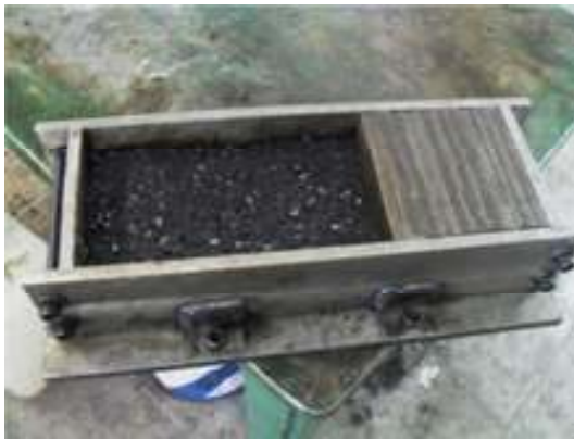
شکل ۵. نمایی از نحوه ساخت و تراکم دال
