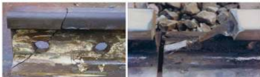
شکل ۱. شکست ناشی از رشد ترک در سوراخ پیچ ریل در محل درز
