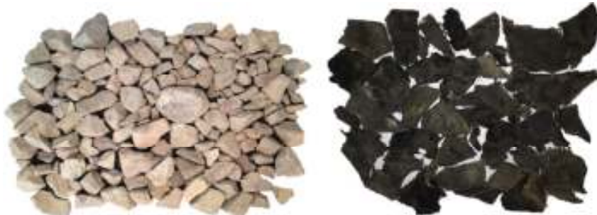
شکل ۵. نمونه دانه‌های بالاست و خرده لاستیک
