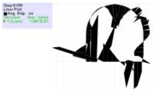
شکل ۱۱. مقدار جابه جایی لایننگ تونل در مواقع قطع
