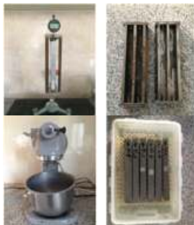
شکل ۱. وسایل و تجهیزات لازم به منظور انجام آزمون انبساط منشور ملات طبق استاندارد ASTM C1260
