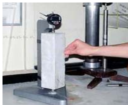
شکل ۲. قرائت انبساط منشور بتن طبق ASTM C1293
