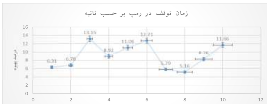
شکل ۱۳. درصد بهبود شاخص زمان توقف، در روش کنترل فازی نسبت به حالت حلقه باز در ۱۰ رمپ مورد بررسی در شهر اصفهان
