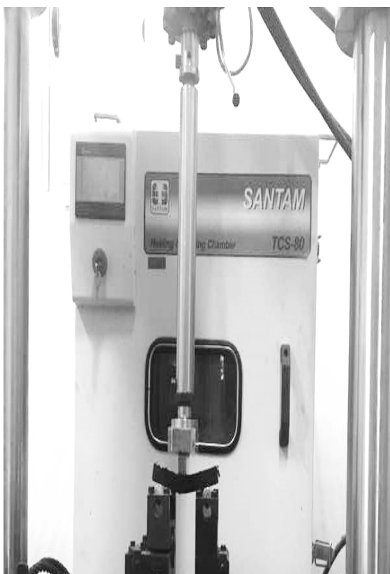
شکل ۲. آزمایش تیرچه خمشی بر روی نمونه مخلوط میکروسرفیسینگ
