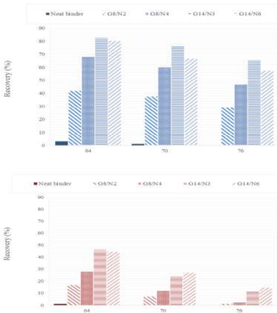
شکل ۴. بررسی تأثیر نانو رس بر خاصیت برگشت‌پذیری قیرهای لاستیکی در سطوح تنش (الف) ۰/۱ کیلو پاسکال . (ب) ۳/۲ کیلو پاسکال
