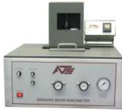
شکل ۱۰. رئومتر تیرچه خمشی (BBR)
