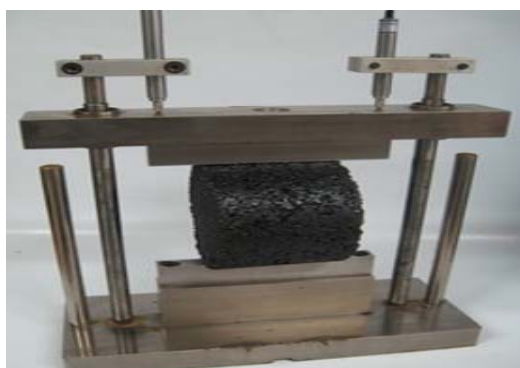
شکل ۲. قاب و شکل بارگذاری آزمایش خستگی بارگذاری کشش غیرمستقیم نمونه تحت آزمایش
