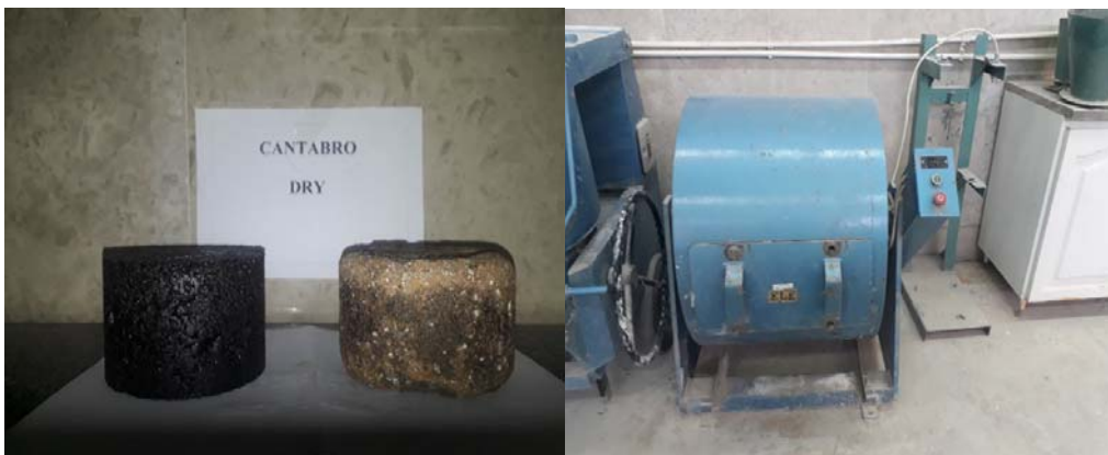
شکل ۴. دستگاه لس انجلس و نمونه‌ها قبل و پس از انجام آزمایش کانتابرو
