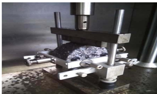
شکل ۵. شکل شماتیک آزمایش کشش غیرمستقیم
