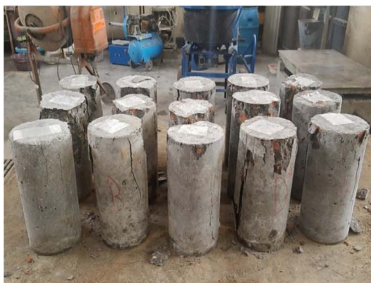
شکل ۸. نمونه‌های بتن غلتکی حاوی خرده آجر پس از بارگذاری در دستگاه جک فشاری
