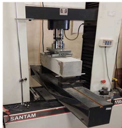
شکل ۷. تیر خمشی حین آزمون
