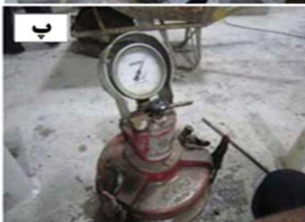
شکل ۶. الف) آزمون مینی اسلامپ، ب) آزمون وزن مخصوص، پ) آزمون درصد هوا
