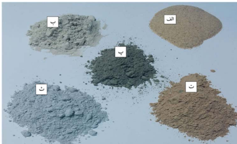
شکل ۲. مصالح مورد استفاده (الف) ماسه سیلیسی، (ب) پودر سرباره کوره آهنگدازی، (پ) سیمان، (ت) سیلیس میکرونیزه، (ث) دوده سیلیس
