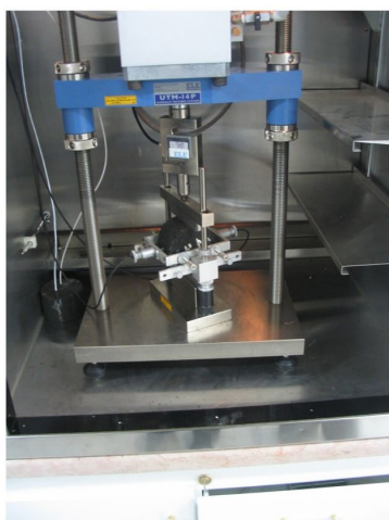
شکل ۴. شماتیک دستگاه و نمونه در حال آزمایش مدول برجهندگی
