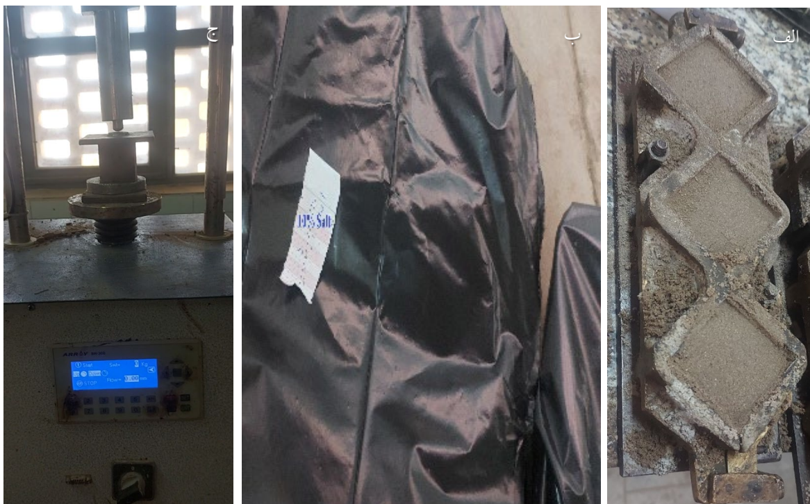
شکل ۳. الف) نمونه‌های ساخته شده در قالب ب) ایجاد شرایط محیط شور ج) دستگاه تعیین مقاومت فشاری
