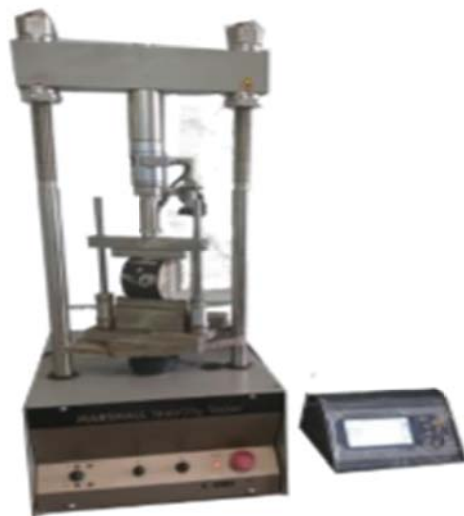
شکل ۲. دستگاه آزمایش کشش غیر مستقیم
