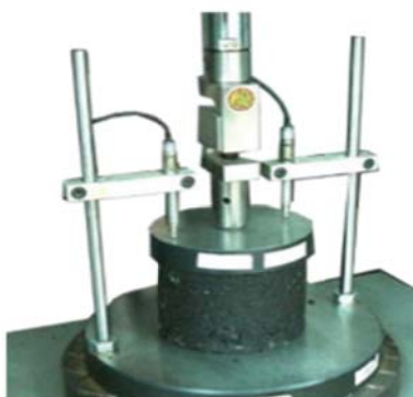
شکل ۵. فک دستگاه UTM5 مربوط به آزمایش خزش
