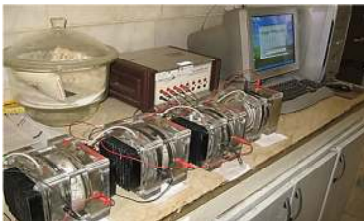
شکل ۶. قرار گیری نمونه‌ها در دستگاه آزمایش هدایت الکتریکی برای اندازه‌گیری مقاومت در برابر نفوذ یون کلر
