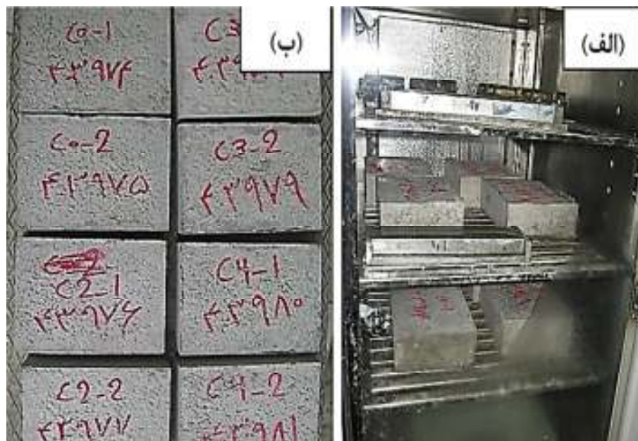
شکل ۷. (الف): عمل‌آوری بلوک‌های بتن‌غلتکی در دستگاه انکوباتور، (ب): نمونه‌های بلوکی بتن‌غلتکی پس از اتمام عمل‌آوری
