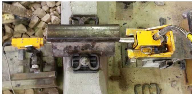
شکل 4. چیدمان جک هیدرولیکی و تغییر مکان سنج در آزمایش مقاومت طولی پابند (یوسفیان، 1393)
