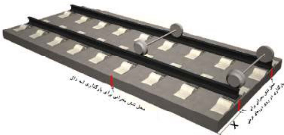
شکل ۱. بارگذاری بر روی لبه کناری و درز عرضی دال بتنی روسازی دال خط راه آهن
