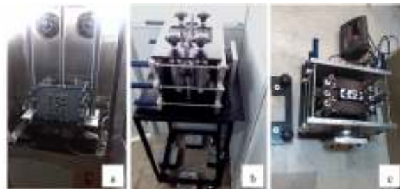
شکل ۲. نمایی از دستگاه اندازه گیری مقاومت برشی بین لایه های روسازی
