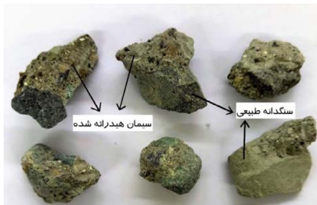
شکل ۱. اجزای اصلی تشکیل‌دهنده سنگدانه بازیافتی بتنی
