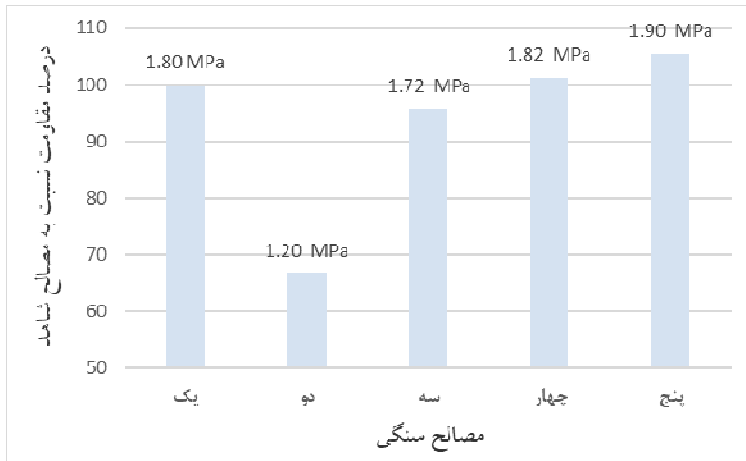
شکل ۹. مقایسه مقاومت کششی نمونه‌های بتن غلتکی با نمونه شاهد
