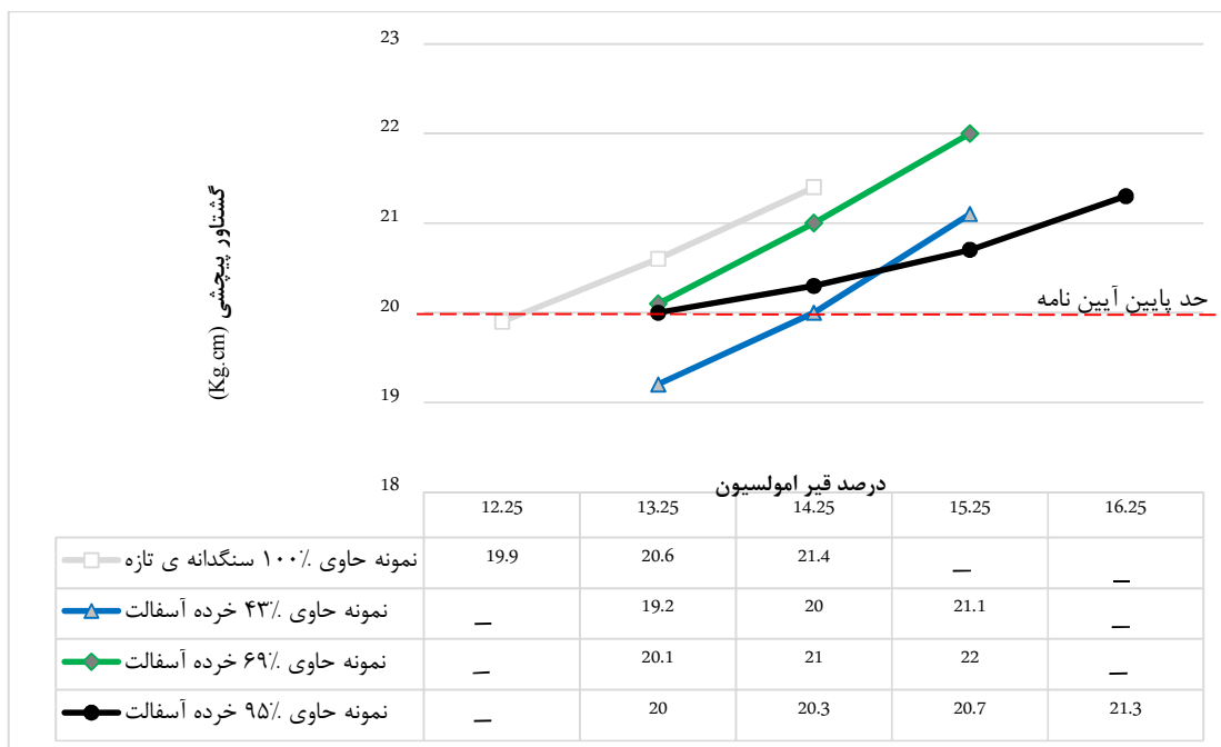
شکل ۵. نتایج آزمایش چسبندگی ۶۰ دقیقه برای همه‌ی نمونه‌ها با ترکیب‌های مختلف مصالح سنگی
