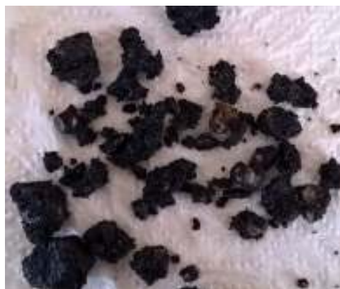
شکل ۷. اندود سنگدانه ها در نمونه های حاوی ۱۰۰ درصد سنگدانه تازه پس از آزمایش عریان شدگی مرطوب
