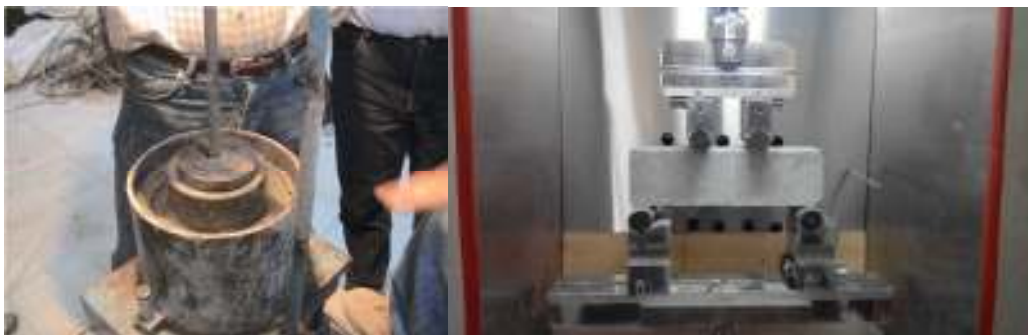
شکل ۳. بارگذاری نمونه تیرچه (سمت راست) برای تعیین انرژی شکست و مدول الاستیسیته و نحوه تراکم کردن نمونه بتن غلتکی در آزمایشگاه-میز وی بی (سمت چپ) (رامی، ۱۳۹۰)
