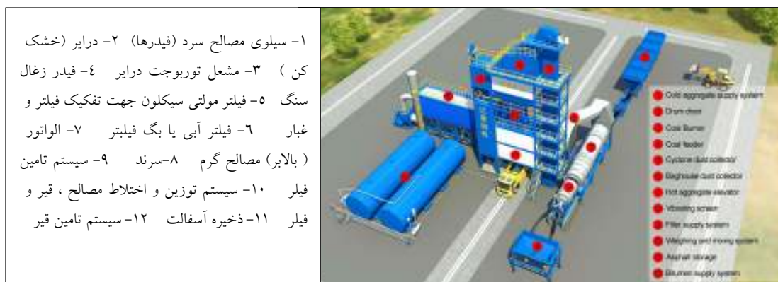
شکل ۱. اجزاء کارخانه آسفالت
