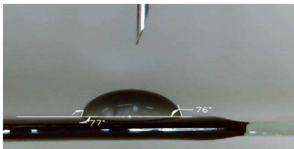
شکل ۳. اندازه‌گیری زاویه تماس قطره اتیلن گلیکول بر سطح قیر
