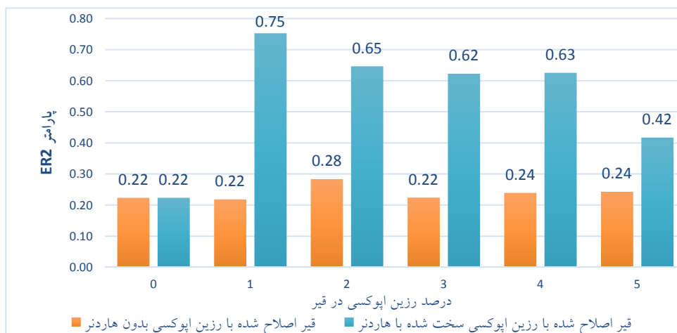
شکل ۹. تغییرات پارامتر ER2 در ترکیب قیر اصلاح شده با رزین اپوکسی و سنگدانه سیلیسی
