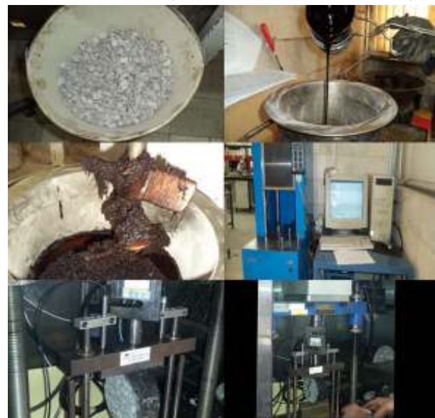
شکل ۱. ساخت نمونه‌ها و انجام آزمایش بارگذاری کشش غیر مستقیم
