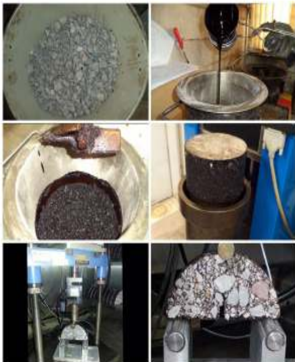
شکل ۲. ساخت نمونه‌ها و انجام آزمایش شکست
