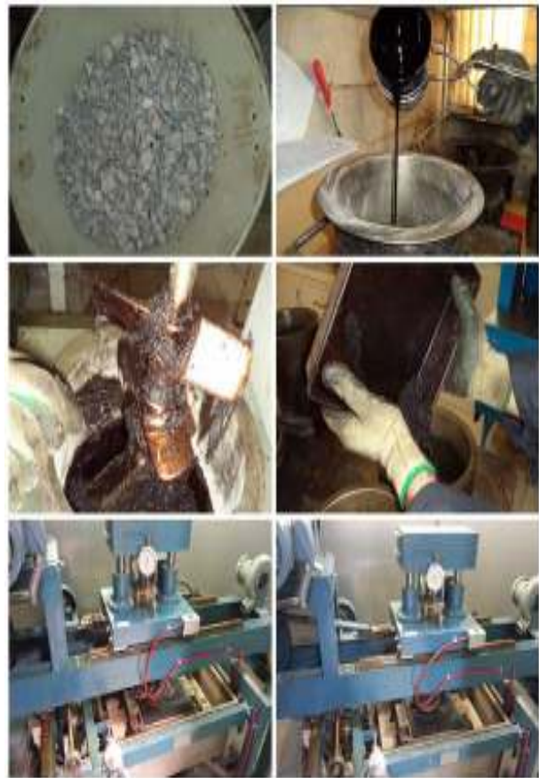
شکل ۲. مراحل ساخت نمونه‌ها و انجام آزمایش شیارشدگی
