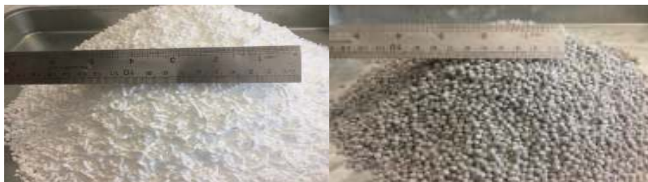
شکل ۱. SBS خام جهت افزودن و اصلاح قیر (بالا) گرانول پلیمر-قیری جهت افزودن و اصلاح مخلوط آسفالتی (پایین)
