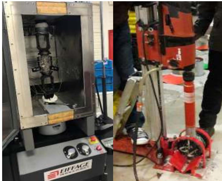
شکل ۲. دستگاه بارگذاری هیدرولیک MTS 370 جهت انجام آزمایشات مدول دینامیکی (بالا) و ابزار طراحی شده برای کرگیری (پایین)
