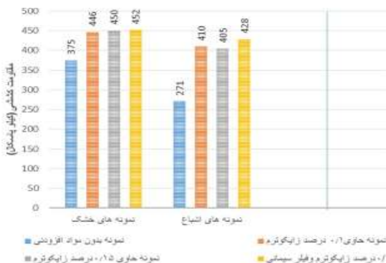
شکل ۱۱. مقایسه نتایج نمونه های بدون افزودنی و نمونه های حاوی ۰/۱ درصد زایکوترم و نمونه های حاوی ۰/۱۵ درصد زایکوترم و فیلر سیمانی
