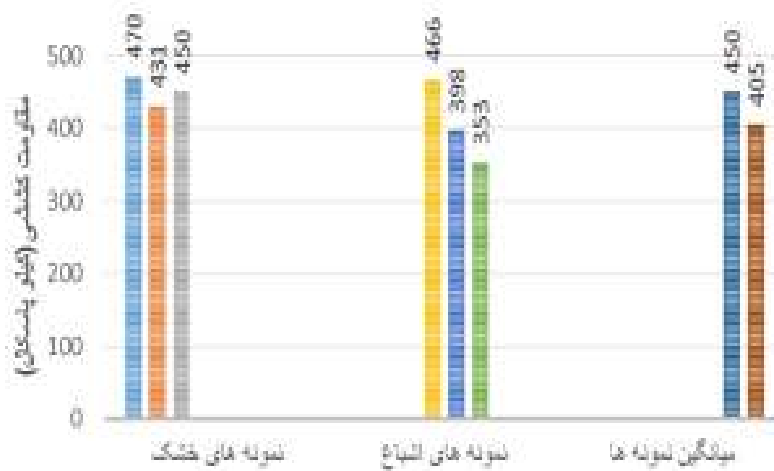
شکل ۸. نتایج مقاومت کششی نمونه های حاوی ۰/۱۵ درصد زایکوترم
