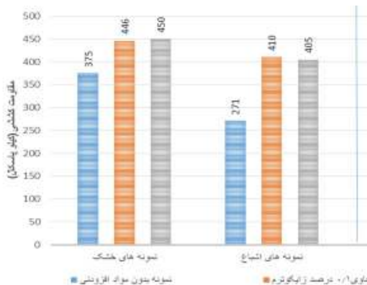
شکل ۹. مقایسه نتایج نمونه‌های بدون افزودنی و نمونه‌های حاوی ۰/۱ درصد زایکوترم و نمونه‌های حاوی ۰/۱۵ درصد زایکوترم
