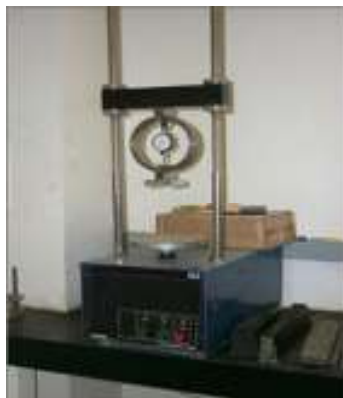
شکل ۶. طریقه انجام آزمایش و نحوه بارگذاری در آزمایش مقاومت کششی غیرمستقیم
