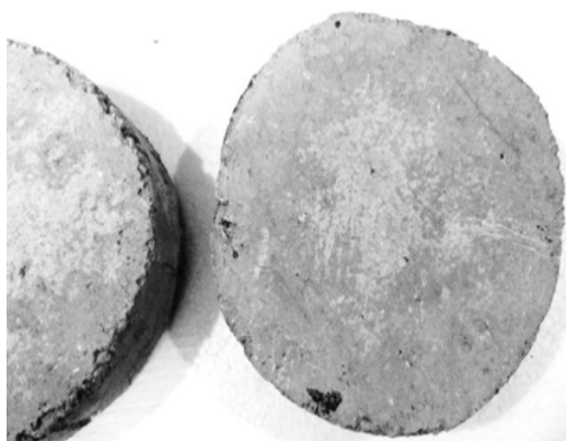
شکل ۲. تصویری از نمونه اساس تثبیت شده سیمانی
