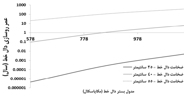
شکل ۱۴. تاثیر سختی بستر و ضخامت دال‌خط بر طول عمر روسازی دال‌خط در حالت مقاومت فشاری ۲۸ روزه بتن ۵۵ مگا پاسکال، بار محوری ۳۲ تن و سرفاصله زمانی اعزام ۵ دقیقه
