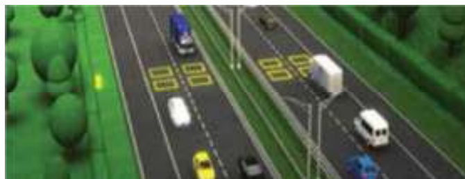
شکل ۳. نمونه‌ای از حسگرهای سیستم حلقه‌ای القایی (صبا، علیمردان و اختیاری، ۱۳۹۲)
