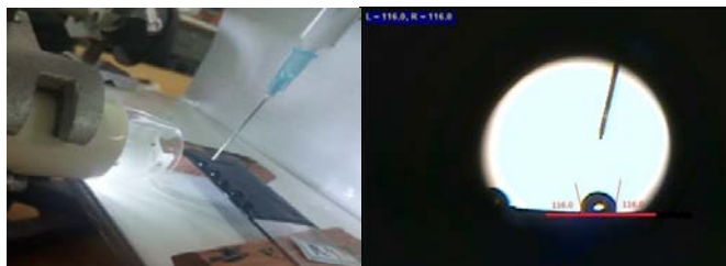
شکل ۳. چگونگی تعیین زاویه تماس در روش SD
