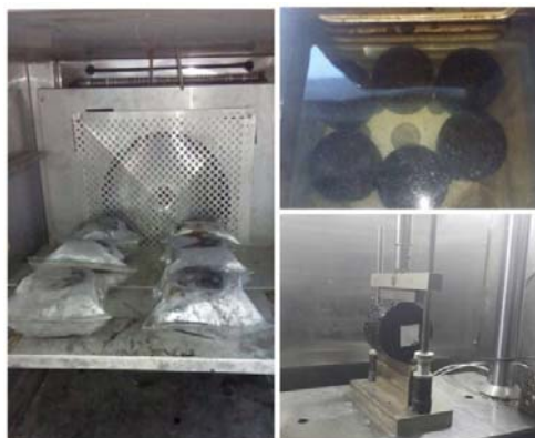
شکل ۴. نحوه انجام آزمایش حساسیت رطوبتی
