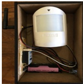
شکل ۶. سنسور HR مورد استفاده در این پژوهش
