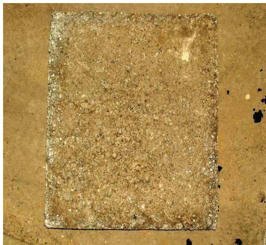
شکل ۳. نمونه بتنی ساخته شده در آزمایشگاه با بافت درشت ایجاد شده به وسیله سنگریزه [۶]
