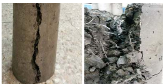
شکل ۵. نمونه‌های استوانه‌ای ارزیابی مقاومت کششی دو نیم شدن مطابق با استاندارد ASTM C496 پس از شکست
