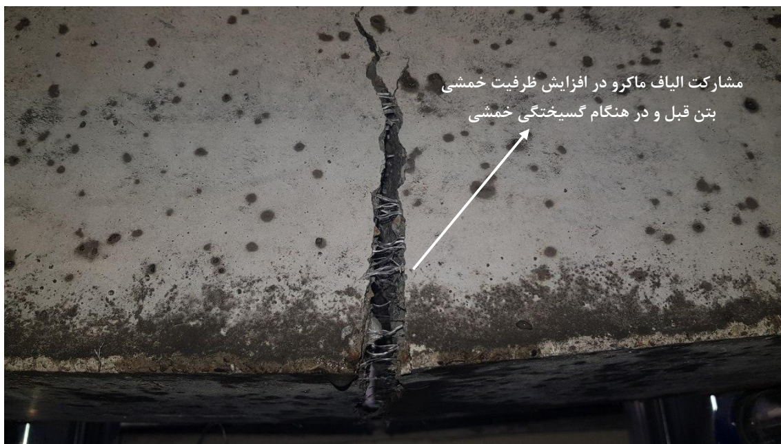
شکل ۱۱. مشارکت الیاف ماکرو در تحمل تنش‌های خمشی وارده به مقطع بتنی قبل و در هنگام گسیختگی خمشی
