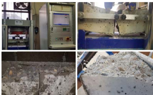
شکل ۷. تیرهای بتنی در حال و پس از اتمام آزمایش تعیین عملکرد خمشی مطابق با استاندارد ASTM C1609
