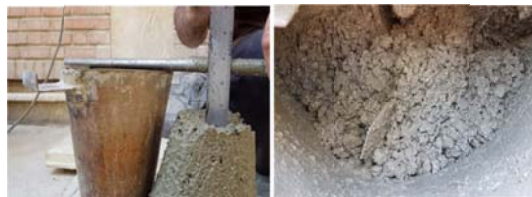
شکل ۳. ساخت و ارزیابی اسلامپ مخلوط‌های بتنی جهت تعیین میزان مصرف ماده افزودنی فوق روان کننده جدول ۴. نسبت‌های وزنی طرح‌های اختلاط مورد بررسی در این تحقیق جهت ساخت یک متر مکعب بتن روسازی بتنی
