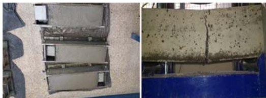
شکل ۶. ساخت و آزمایش تیر های بتنی جهت تعیین مقاومت خمشی بتن مطابق با استاندارد ASTM C78
