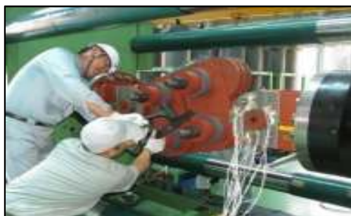
شکل ۵. آزمایش میراگر اصطکاکی دورانی ۱۵۰۰ کیلونیوتن شرکت دمپتک
