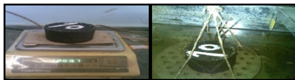
شکل ۲. توزین نمونه‌های آسفالتی در هوا و آب
