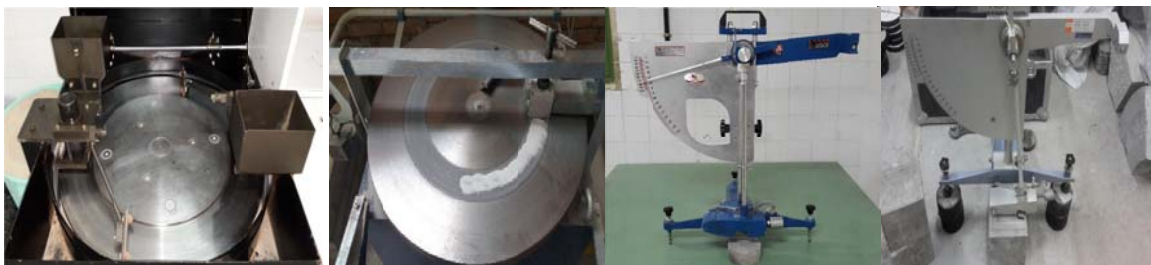
شکل ۴. نمونه‌ای از تصاویر دستگاه سایش بوهم و دستگاه پاندول اصطکاک (نمونه‌های مکعبی ۱۰ سانتی‌متر)
