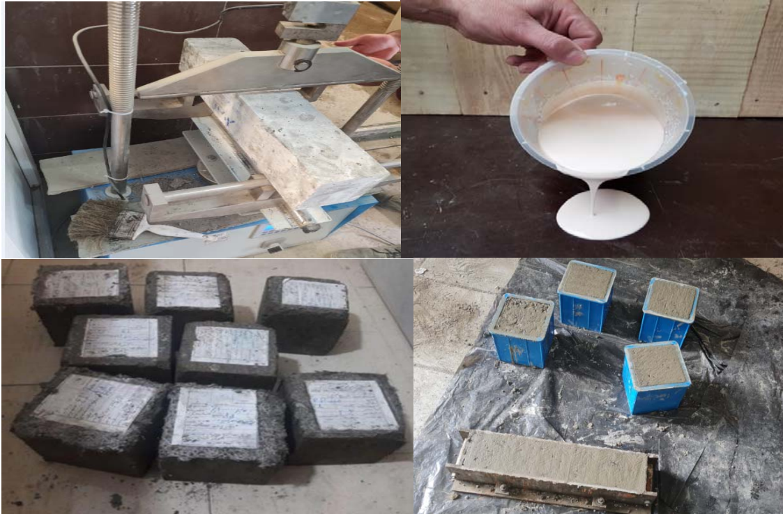
شکل ۳. رزین آکرلیک مصرفی و نمونه‌های ساخته شده روسازی بتنی
