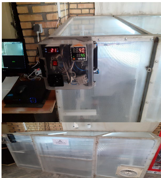
شکل ۶. محفظه کنترل شرایط محیطی و دال بتنی تحت آزمایش
