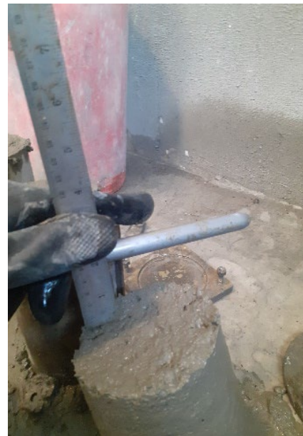
شکل ۸. ارزیابی میزان روانی مخلوط بتن روسازی بتنی مطابق با استاندارد ASTM C143
