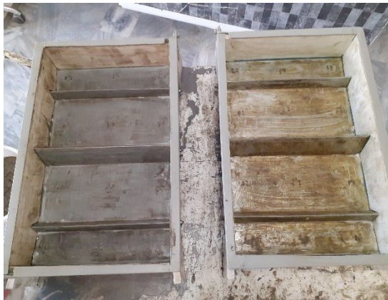
شکل ۵. قالب و ابزار فولادی مورد استفاده در تحقیق مطابق با استاندارد ASTM C1579
