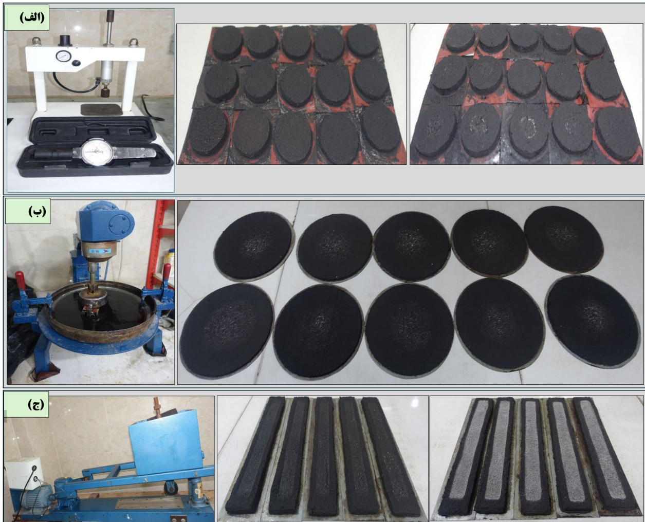
شکل ۲. آزمایش‌های عملکردی نمونه‌های اسلاری سیل: الف) آزمایش چسبندگی، ب) آزمایش سایش در شرایط مرطوب و ج) آزمایش چرخ بارگذاری- جابه‌جایی و چرخ بارگذاری-چسبندگی ماسه
