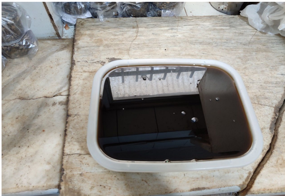
شکل ۲۲. قرارگیری نمونه های مارشال در ظرف حاوی بنزین جهت آزمایش مقاومت در برابر سوخت
