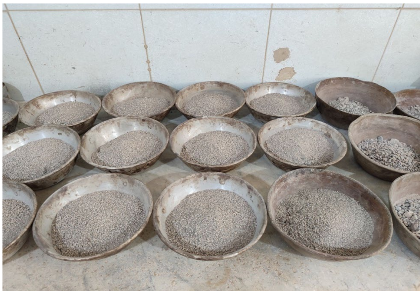
شکل ۱۰. جداسازی نمونه و تفکیک مصالح با توجه به نسبت‌های اختلاط
