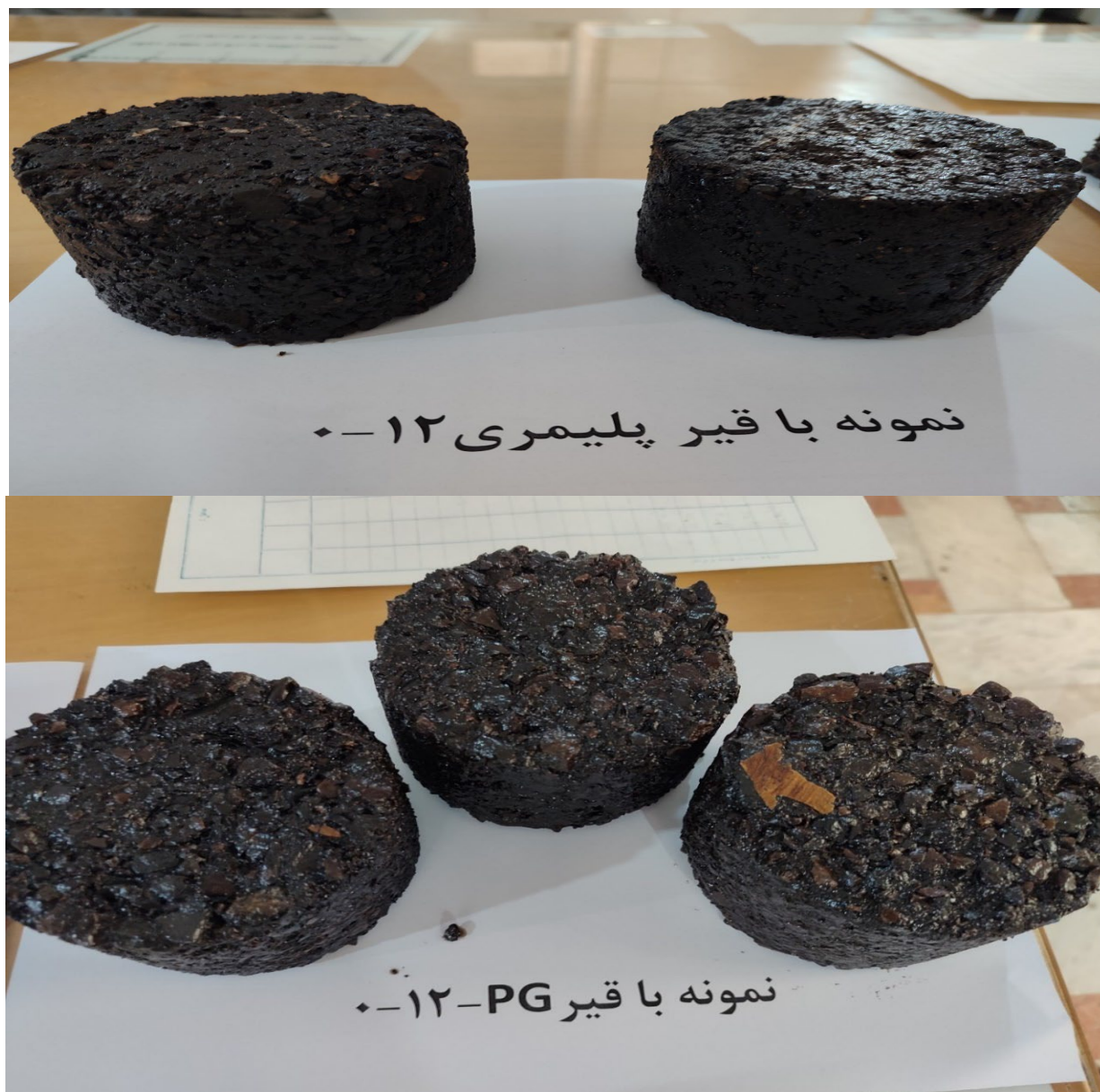
شکل ۲۳. نمونه‌های مارشال پس ۲۴ ساعت فرارگیری در بنزین برای توپکا ۱۲-۰
