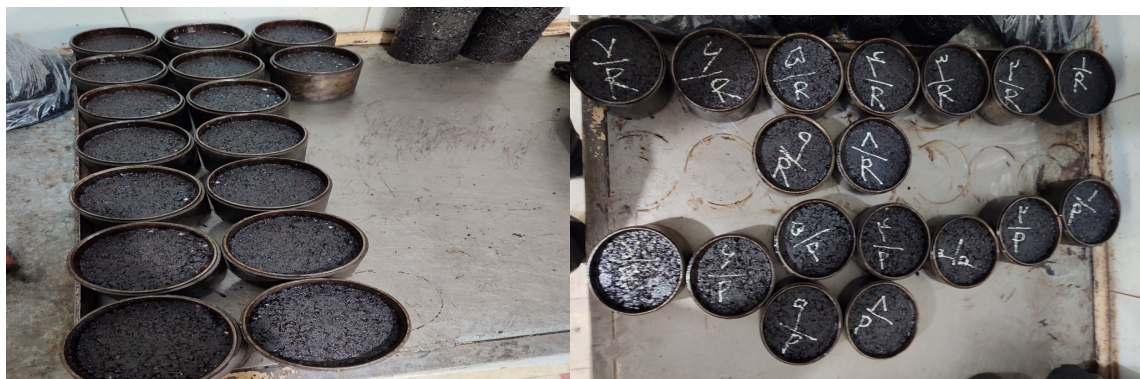
شکل ۸. ساخت نمونه های مارشال با درصد قیر های مختلف برای انجام آزمایشات
