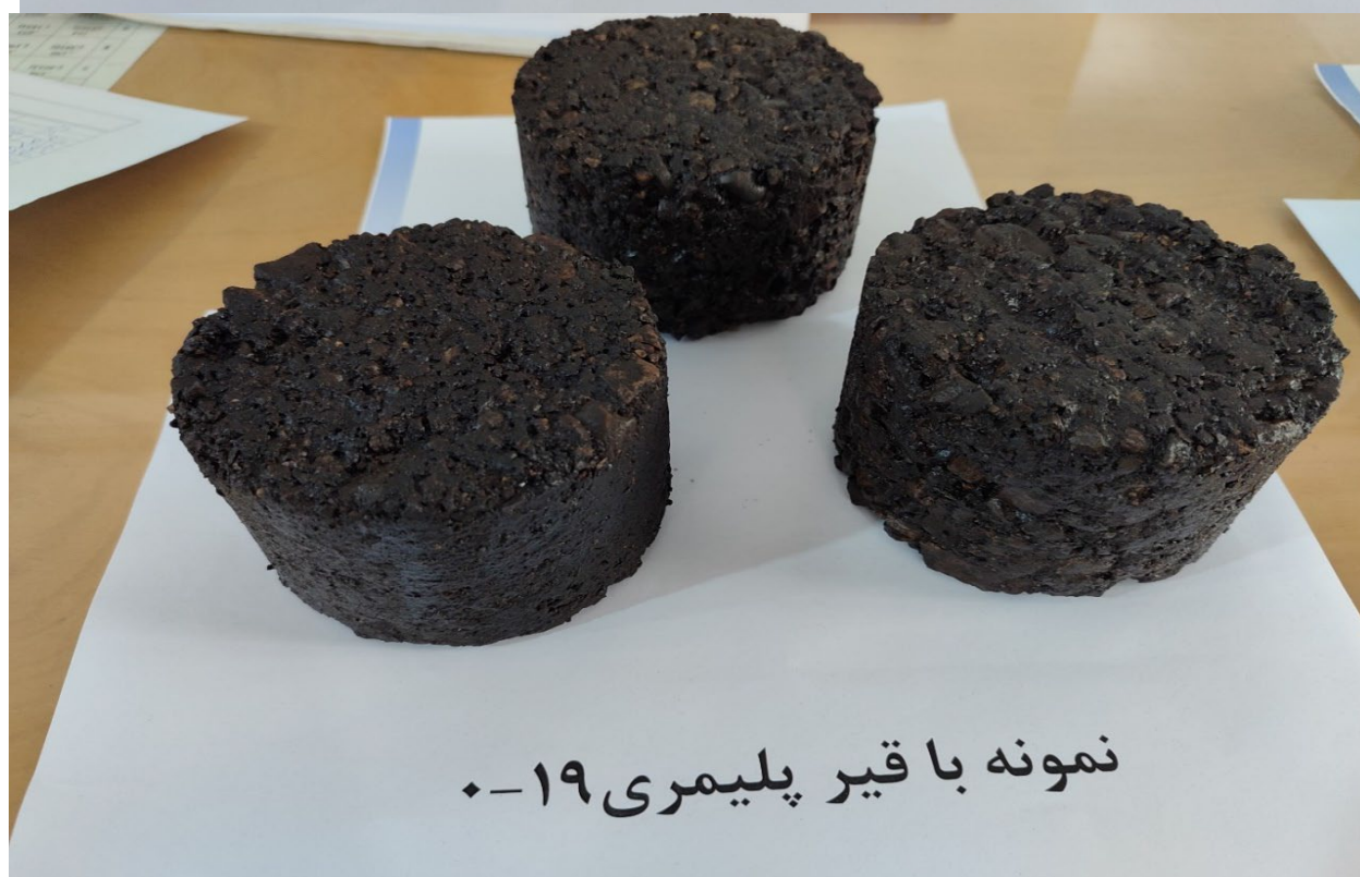
شکل ۲۴. نمونه‌های مارشال پس ۲۴ ساعت قرارگیری در بنزین برای توپکا ۱۹-۰
