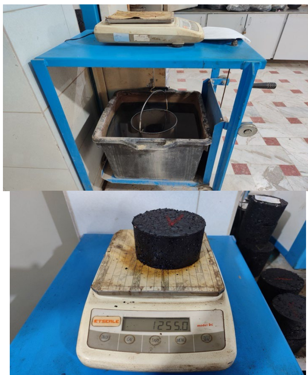
شکل ۱۳. وزن نمونه های مارشال با استفاده از میز ارشمیدس
