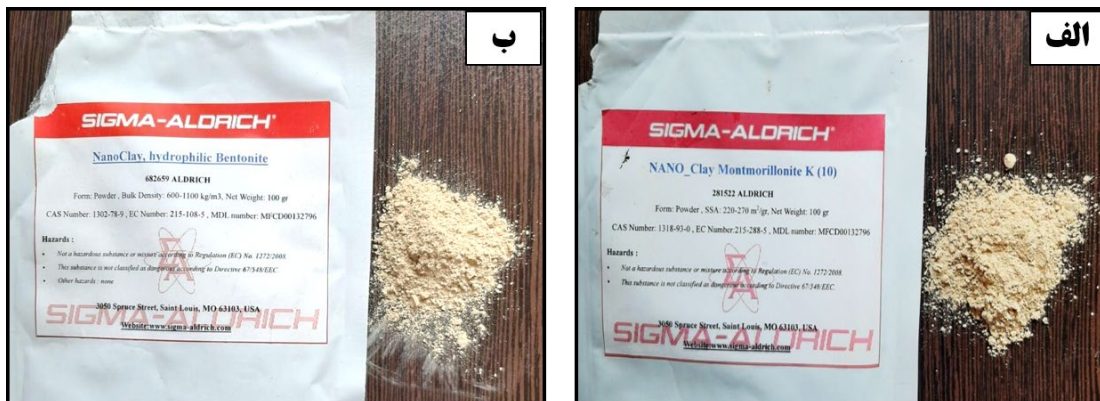
شکل ۲. نانو رس های مورد استفاده، الف) نانو رس مونت موریلونیت و ب) نانو رس بنتونیت
