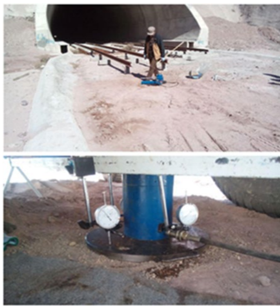
شکل ۲. آزمایش بارگذاری صفحه در ورودی تونل کوهین
