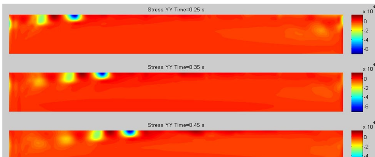
شکل ۱۵. تنش قائم بستر در زمان های مختلف با حرکت بار به سمت راست
