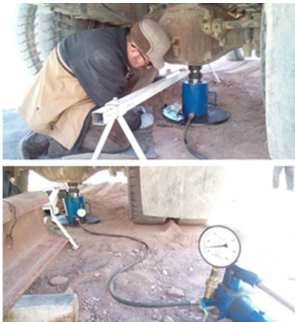
شکل ۲. آزمایش بارگذاری صفحه در ورودی تونل کوهین
