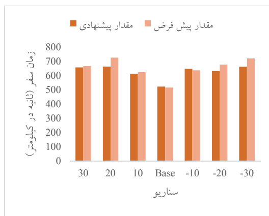
شکل ۸. زمان سفر در تقاطع فلزی-ملت در دو حالت پیشنهادی و پیش فرض
